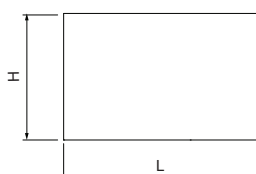
Obr. 3: Velikost stavebního otvoru (H = výška, L = délka)
